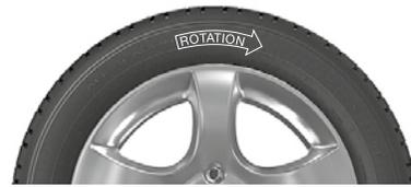
Beispiel einer Kennzeichnung der Laufrichtung
